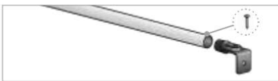
1 - Fixez les terminaison murale à l'aide des vis autoforeuse 4,8 x 25
