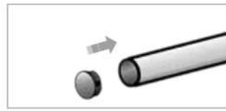
11 - Enfin, insérer les bouchons ou les terminaisons murales aux lisses et sous-lisses.
