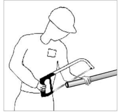
12 - Ajuster le dernier tronçon en sciant l'excédent rétreint.
