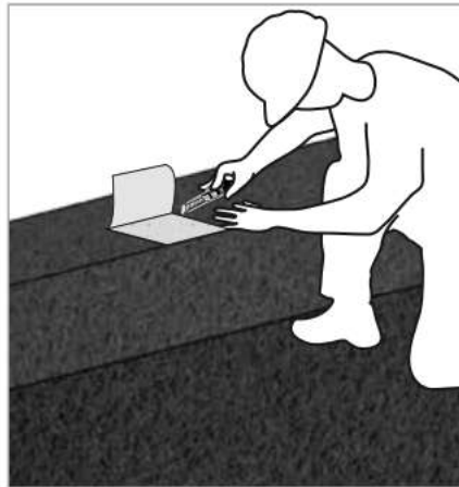
3 - Les sabots Z doivent être fixés directement sur l'acrotère. Si l'étanchéité le recouvre, découper à l'emplacement de chaque sabot z.
