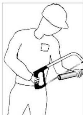
12 - Ajuster le dernier tronçon en sciant l'excédent rétreint.
